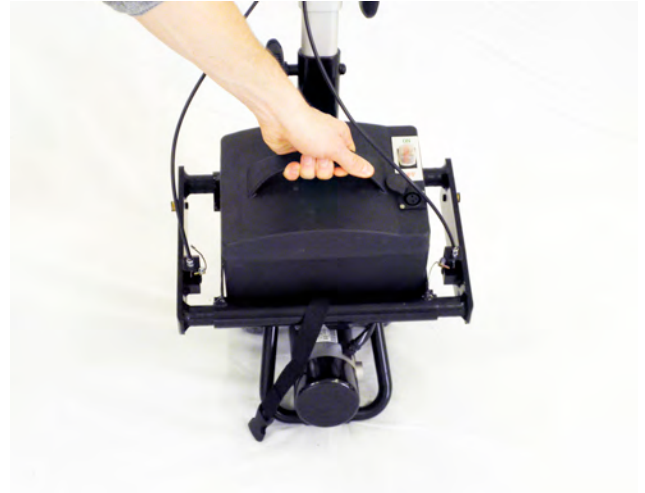
Abbildung 51: Abnehmen der Akkubox
